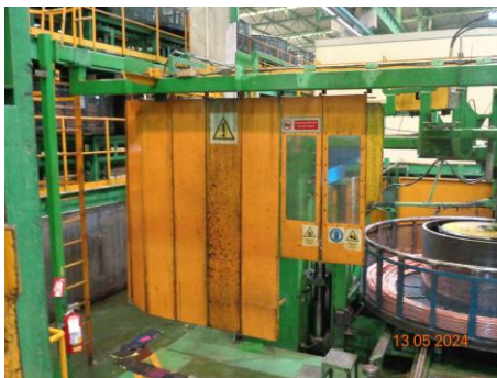
ภาพที่ 2.2-28 การปิดครอบเครื่องจักรที่มีเสียงดัง เพื่อลดระดับเสียง
