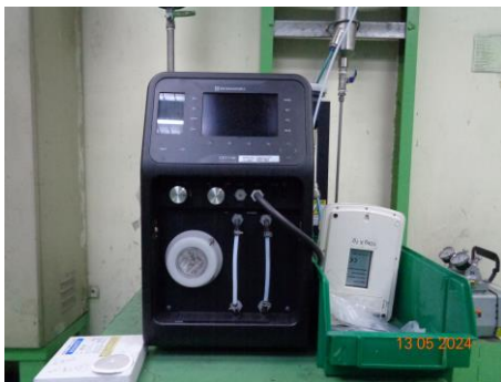
ภาพที่ 2.2-4 การติดตั้ง CO Analyzer บริเวณเตาหลอม
