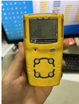
อุปกรณ์ตรวจจับก๊าซ (Gas Detector)
